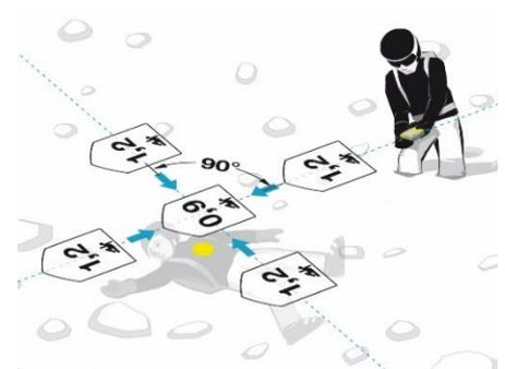
Machen Sie bei der Feinsuche keine schnellen Bewegungen, reduzieren Sie beim Auskreuzen die Suchgeschwindigkeit auf 10 cm/s und vermeiden Sie Drehen/Schwenken! Suchen Sie entlang der Y-Achse bis zum Punkt der geringsten Entfernungsanzeige, suchen Sie dann entlang der X-Achse. Suchen Sie immer über den Punkt der geringsten Entfernungsanzeige hinaus um die Distanzanzeige zu verifizieren. Markieren Sie den Punkt der geringsten Entfernungsanzeige und beginnen Sie mit dem systematischen Sondieren.
