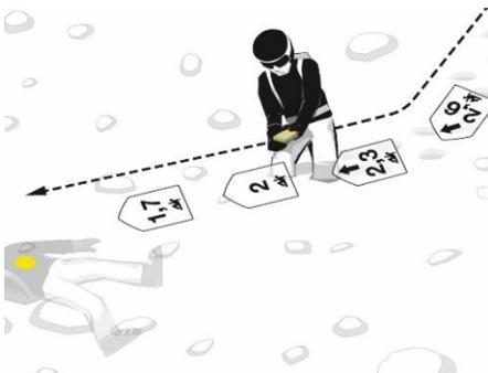
Führen Sie die letzte Richtungskorrektur exakt aus, bevor der Richtungspfeil ausgeblendet wird. Sie bewegen sich dann in bester Koppellage auf das Sende-LVS-Gerät zu und sparen Zeit beim Auskreuzen.
